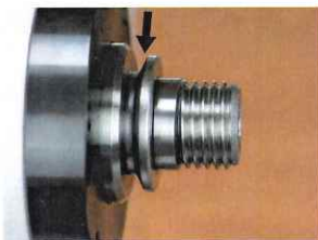
Abb. 1: Spindelanschluss mit Ablaufsicherungsnut
